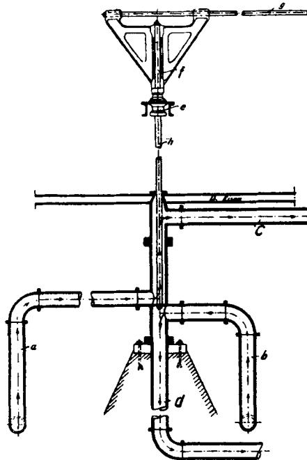
sich drehender Saugrüssel, dad. gek., daß der eine Saugrüssel durch die hohle Achse mit einer oberen Schlammabführung (c) und der andere mit einer unteren Schlammabführung (d) in Verbindung stehen. — Sehr verbessert wird die Betriebssicher-
