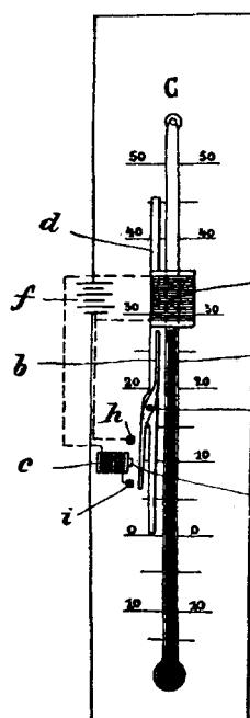
peratur eine elektrische Alarm- oder Signaleinrichtung in Tätigkeit setzen. (D. R. P. 403 305, Kl. 74 b, vom 27. 11. 1923, ausg. 30. 9. 1924.) dn.
