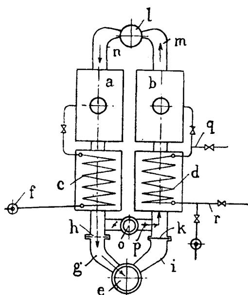
Heißwasserspeicher dienenden Kessels (b) geführt wird, daß die kalte Luft mit diesem Kessel nicht in Berührung kommt. — Der Economiser, der zu diesem Zweck von Wasser entleert sein muß, wird in bekannter Weise mit Zwischen- oder Abdampf geheizt. Der Economiser dient also als Wärmeaustauschapparat in umgekehrtem Sinne wie in normalem Betrieb; er ist hierzu, wie eine einfache Nachrechnung ergibt, ohne weiteres imstande. (D. R. P. 403 555, Kl. 24 k, vom 11. 1. 1923, ausg. 2. 10. 1924.) dn.
