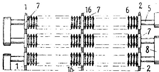
(1, 2, 16) derart gelagert sind, daß sich die Röhre unabhängig voneinander relativ zu den Stützwänden verschieben können und mitsamt ihrer rippenförmigen Ummantelung durch die Öffnungen der Stützwände herausgezogen werden können. (D. R. P. 403 379, Kl. 13 b, vom 14. 4. 1923, ausg. 27. 9. 1924.) dn.
