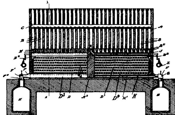
der Mitte des Ofens im Querschnitt abnehmen. — Dadurch wird stets die erforderliche Strömungsgeschwindigkeit ohne die Möglichkeit des Auftretens von Wirbelströmungen erreicht. (D. R. P. 401 108, Kl. 10 a, vom 30. 9. 1920, Prior. V. St. A. 14. 6. 1917, ausg. 28. 8. 1924.) dn.
