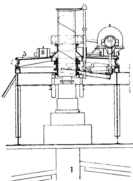
einer gemeinsamen Zwischenwelle abgenommen werden, während durch die gleichzeitig erfolgende Drehung der Plattform (5) die Rührwerkswelle (1) entsprechend der Steigung der Herdsohle auf- und abwärts verschoben wird, in dem Sinne, daß die Anfangs- und die Endstellungen der Rührflügel bei ihren Winkeldrehungen ständig vorschreiten. Weitere Anspr. u. Zeichn. (D. R. P. 403 565, Kl. 40 a, vom 14. 2. 1922, ausg. 2. 10. 1924.) dn.
