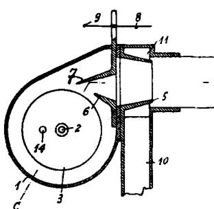
Brennstoff aus einer oder mehreren Zuleitungen zugeführt wird, wobei zum Ableiten des abgespritzten Brennstoffes zur Verbrennungsstelle eine Öffnung im Gehäuse vorgesehen ist, dad. gek., daß vor der Gehäuseöffnung ein mit einer tangential oder annähernd tangential gerichteten Ablenkplatte versehener Schieber (7) angebracht ist. —
